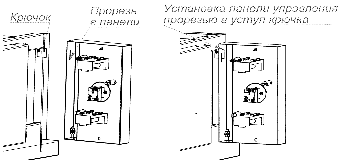
Рис. 8 Схема установки панели управления при ТО
